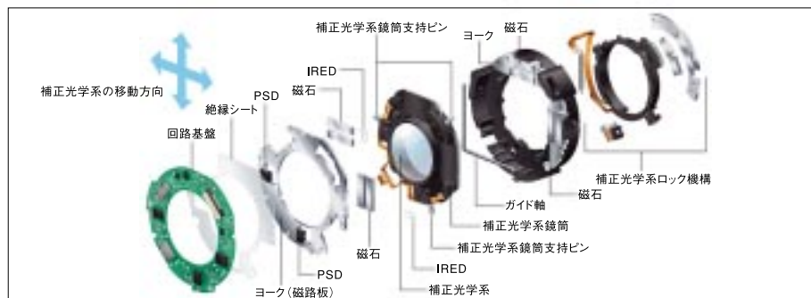
EF70-200mm F2.8L IS USM 用ISユニット
