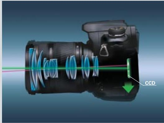
DYNAX 7D防手震功能具有獨一無二的CCD移位機制，比其他相機的防手震補償系統更勝一籌。此系統由高度靈敏的角速率感應器（angle-speed sensor），以及特別為DYNAX 7D大尺寸CCD所設計的全新平順碰擊驅動機制（SIDM）所組成，不但可迅速且精確地移動CCD，並能有效地抵消相機震動。該CCD移位機制可讓您使用比平常慢2至3級的快門速度進行拍攝，即使在光線不足的環境下，提高ISO感光度進行拍攝時，影像依然清晰銳利，不會出現雜訊。由於該CCD移位機制直接置於相機內，因此可兼容任何一款DYNAX AF鏡頭——這是DYNAX 7D的另一個主要優點。
