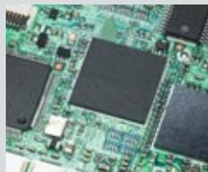
DYNAX 7D先進的影像處理器具有三個獨立的處理模組，能顯著提升影像質素、處理資料的速度及拍攝影像的反應。由於模組可在不影響相機表現的情況下，使用極精密的演算方法，同時進行多項複雜的處理工作，令雜訊與信號干擾大幅減少，而影像質素亦因此提高。此外，專為DYNAX 7D而設計的全新影像處理器採用了柯尼卡美能達獨有的技術來處理大量高解像度的影像資料，使DYNAX 7D的拍攝反應足可媲美單鏡反光菲林相機。
