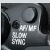
DYNAX 7D 擁有4種對焦模式，可在各種不同的拍攝環境下提供最佳的拍攝表現：適用於拍攝單張AF的AF-S模式、連續AF的AF-C模式，以及在偵測到拍攝主體移動時，從單張AF自動切換至連續AF的AF-A模式。DYNAX 7D 設有如DYNAX 7 一樣的AF/MF操控按鈕，只要用右姆指便能立即切換自動對焦及手動對焦，而不會影響距離資料傳輸至相機的測光、防手震及先進綜合距離(ADI)閃光系統的操作，方便容易。此外，另一個對焦選擇是直接手動對焦(DMF)，此功能對微距及人像拍攝特別有用。當在此模式下半按下快門釋放按鈕時，
