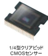
イメージセンサーには、ハイビジョン用に新開発された「3クリアビッド CMOSセンサー」を採用。ソニー独自の画素配列により、高画質な映像記録が可能に。R・G・Bの3つの色成分を3枚のセンサーで独立してとらえることで、優れた色再現性を実現しています。同時に、受光面積を大きくできるため高感度で撮影できます。
