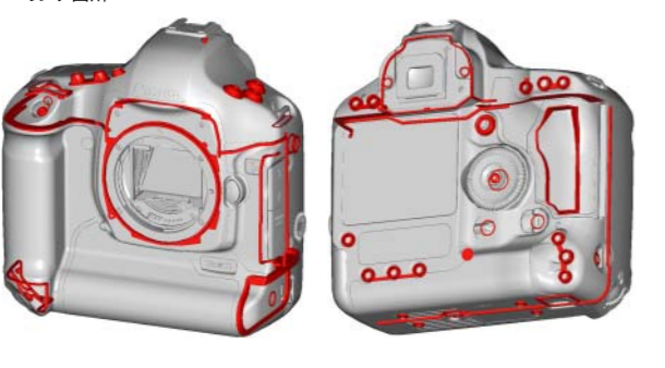
シーリング箇所
