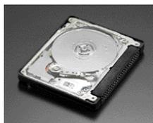
以懸浮式懸掛減震系統設計，完全吸收了外部搖晃所產生的震動干擾。為了使硬碟攝影機能順利運轉，所以更需要避免硬碟的震動與衝撞的特殊結構設計。因此對Everio來說，它的內部結構即以精密的14層聚合物吸震墊包覆著，讓硬碟處於懸浮的狀態，因而在攜帶或使用Everio時所產生的一些震動與衝撞就能被有效的消抵，大幅強化了硬碟的穩定性。
