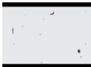
※一眼レフカメラでは、普通、センサー部の右下にある異物は画像や液晶モニターの左上にあらわれますが、ダストアラート機能では撮像素子部を実際に見たのと同位置に補正、輪郭を強調して表示します。
